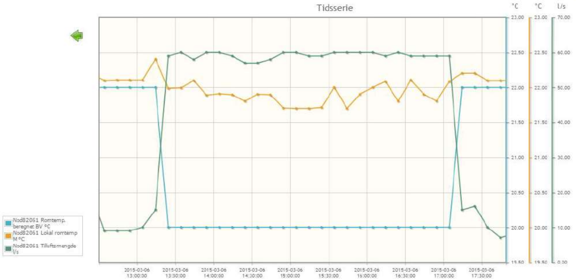
Figur 16: Utklipp fra Lindinspect som illustrerer sammenheng mellom settpunktverdi, luftmengde og romtemperatur
